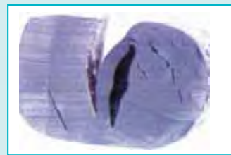
由于爆炸分解而导致O型密封圈损坏
